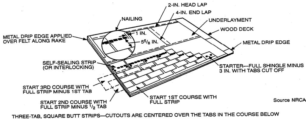
**ASPHALT ROOFING SHINGLES APPLICATION HIGH SLOPE (4:12 MINIMUM)**
